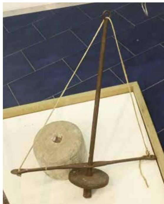
il basso dell'asta orizzontale, mentre il ritorno avveniva per la rotazione della cordicella. Con il tempo venne creato il **trapano a manovella**, in ferro e con punta intercambiabile del diametro desiderato, per la realizzazione di fori comunque non di grandi dimensioni sui pezzi in lavorazione.
