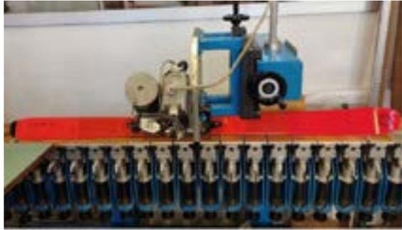
Il banco prova ELP (Edge Load Profile) sviluppato su brevetto del Prof. Vittorio Quaggiotti e utilizzato per la rilevazione della curva di carico sulla neve durante la curva (Petrone, 2012).
