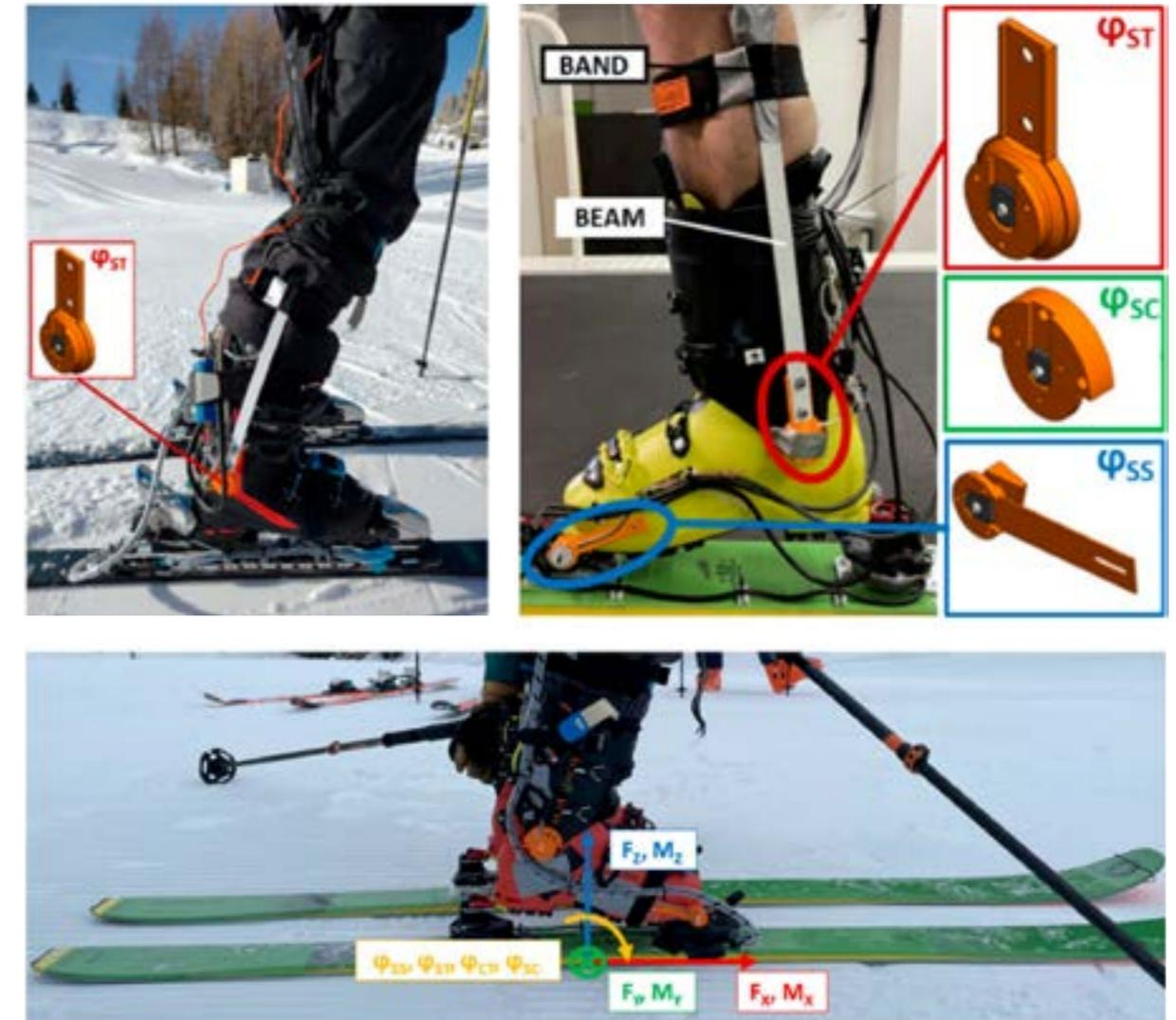
Sci da discesa e da sci alpinismo sono testati sia in discesa che in salita, per poi ottenere dopo un opportuno lavoro di elaborazione i valori di forza e momento di reazione al centro sci e i valori cinematici ottenuti come curva media sia nel caso di slalom in discesa sia sul passo medio in caso di salita.
